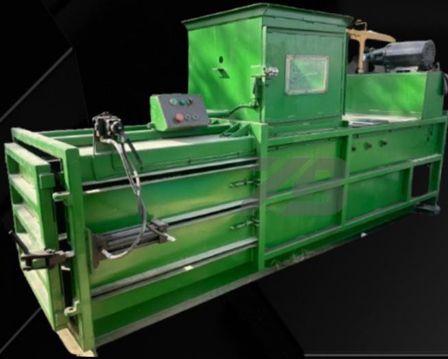
COMPACTADORA: Horizontal de compuerta
